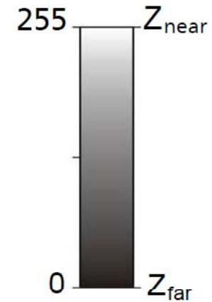
Depth Image based Rendering (DIBR) zur Zwischenbildgenerierung
